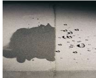
La mitad de esta arenisca ha sido tratada con los productos Fila y la otra mitad no. En la parte tratada, a la derecha, se puede observar el particular efecto gota del agua. En la parte sin tratar el agua penetra de inmediato en el material.
